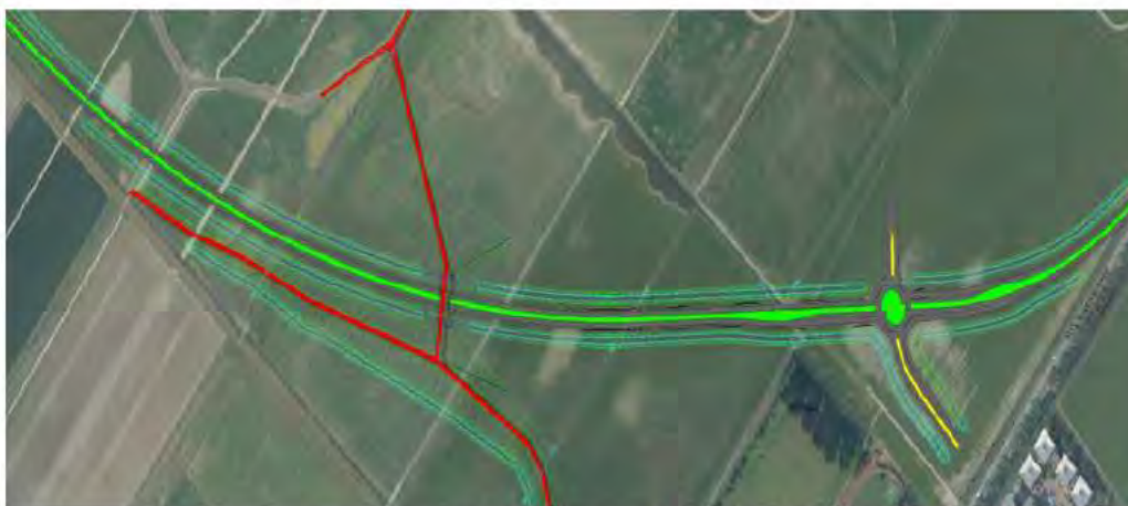
Figuur 4: Voorlopig wegontwerp (groen) voor de Verlengde Bentwoudlaan, inclusief nieuwe rotonde en nieuwe fietspaden (rood). De rotonde moet de Verlengde Bentwoudlaan verbinden met de N455/Hoogeveenseweg.
