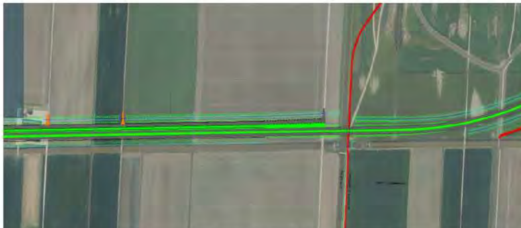
Figuur 2: Voorlopig wegontwerp (groen) voor de Verlengde Bentwoudlaan, inclusief een nieuwe parallelweg en fietspad (rood). De parallelweg moet toegang bieden tot landbouwpercelen.
