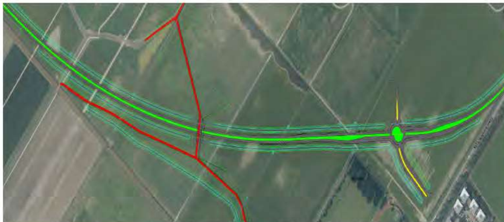
Figuur 7: Wegontwerp (groen) voor de aanleg van de Verlengde Bentwoudlaan, rotonde en nieuwe fietspaden (rood). De rotonde moet de Verlengde Bentwoudlaan verbinden met de N455/Hoogeveenseweg. De fietspaden moeten een recreatieve verbinding vormen tussen Waddinxveen en het Bentwoud.
