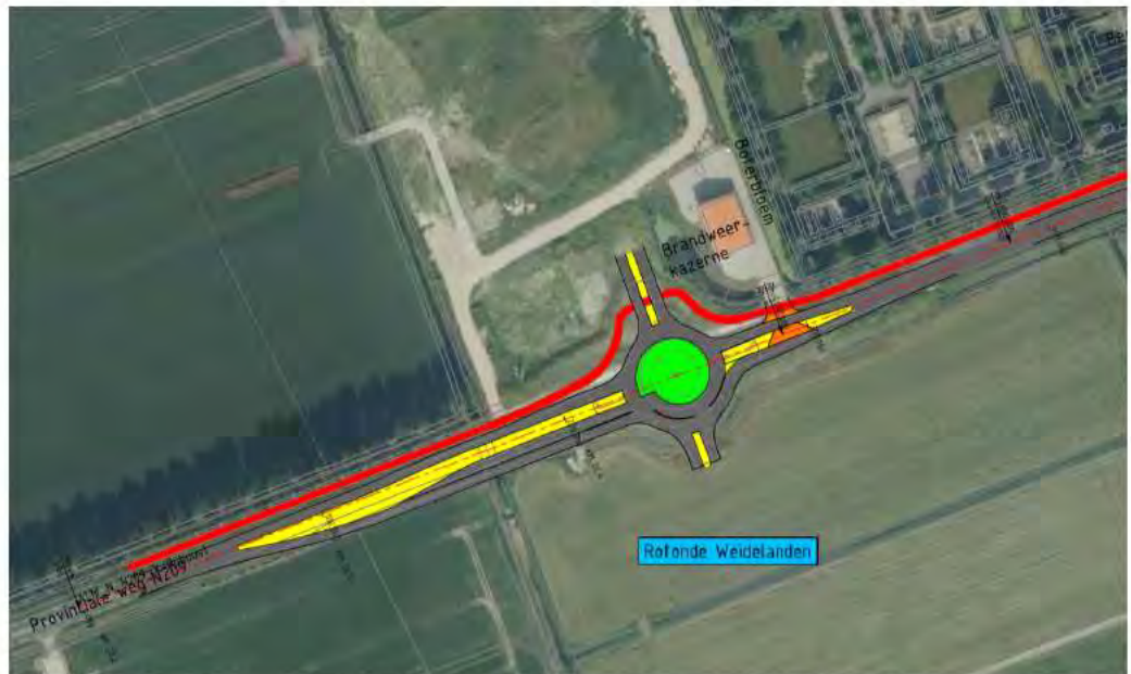
Figuur 8: Uitbreiding van de rotonde bij de nieuwe woonwijk Weidelanden en de aanleg van een extra rijstrook (beide varianten).
