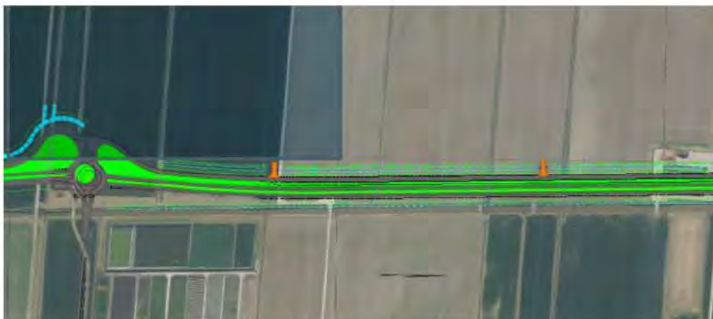
Figuur 3: Voorlopig wegontwerp (groen) voor de Verlengde Bentwoudlaan, inclusief een nieuwe parallelweg en rotonde.
