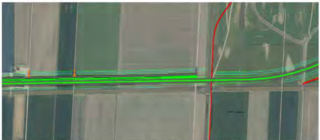
Figuur 6: Wegontwerp (groen) voor de aanleg van de Verlengde Bentwoudlaan, inclusief een nieuwe parallelweg en fietspad (rood). De parallelweg moet toegang bieden tot landbouwpercelen. Het fietspad moet een recreatieve verbinding vormen tussen Waddinxveen en het Bentwoud.
