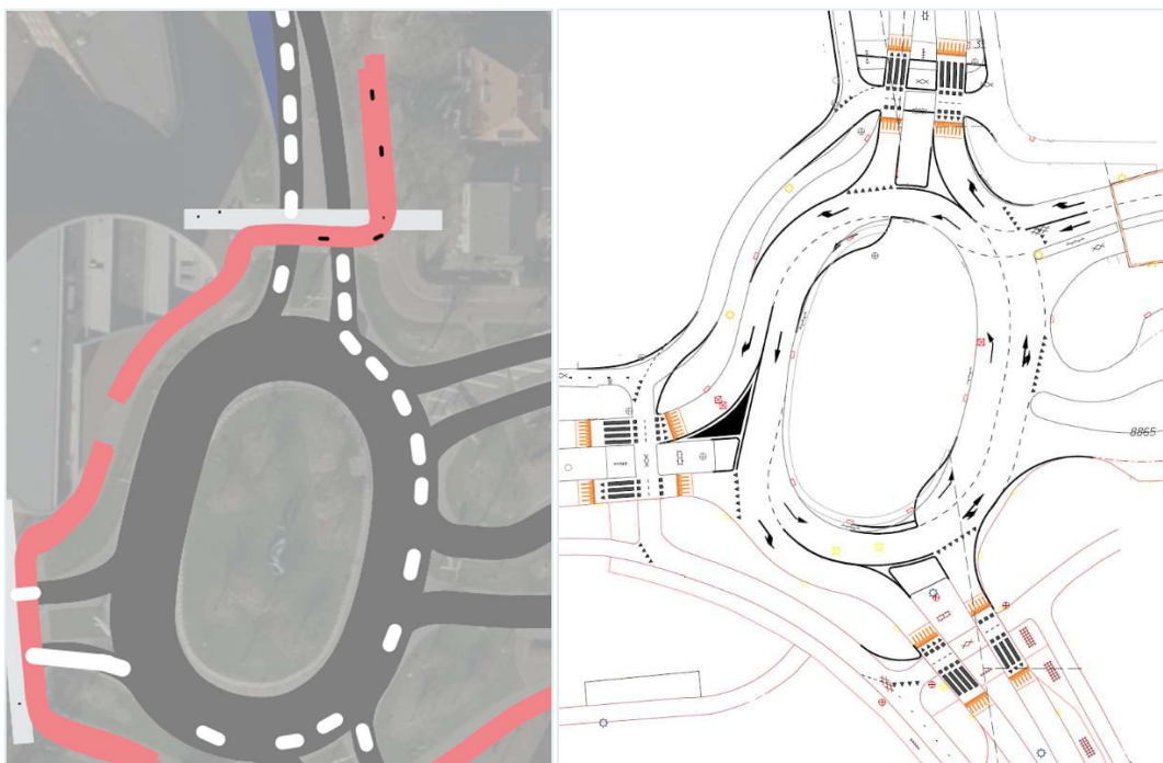
Figuur 2.5: linkerzijde: screenprint uit Vissim, variant 3 met fietsers in de voorrang. Rechterzijde: nieuw ontwerp met andere rijstrookindeling en fietsers en voetgangers in de voorrang.
