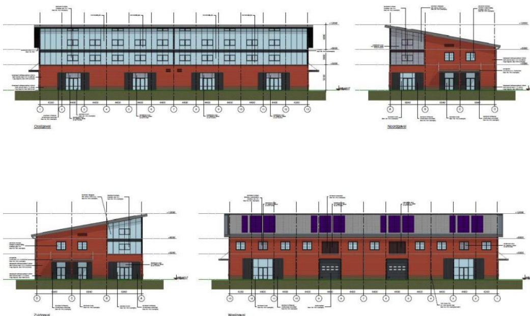
Het in aanbouw zijnde bedrijfsverzamelgebouw NOVA, hoge gevel richting Rijnhaven-oost, lessenaar-dak naar het westen
